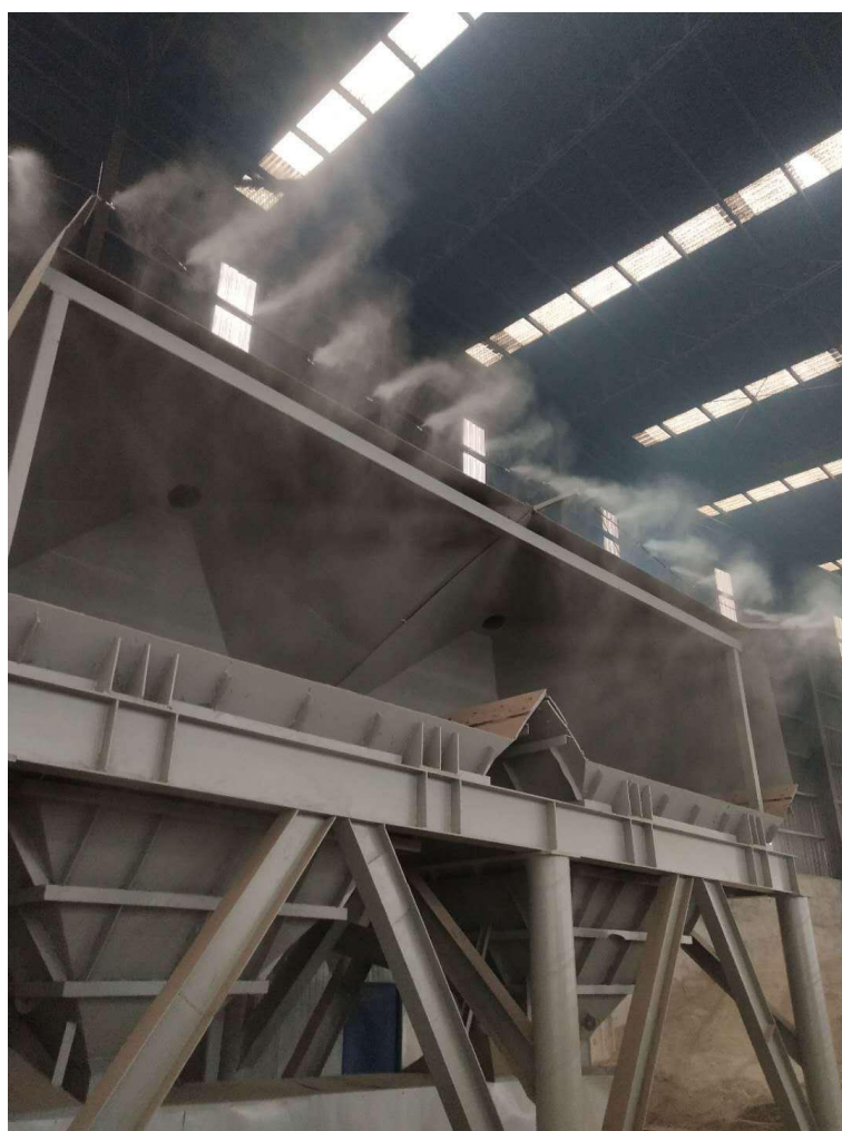
图 2-1 原料仓照片（顶部设置雾化喷嘴）
