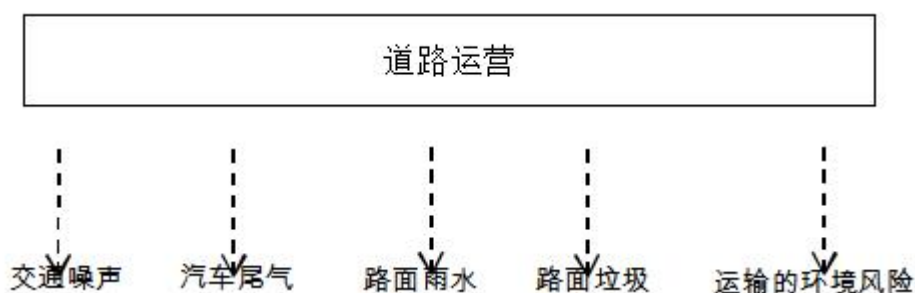
图 4-1 运营期工艺流程及产污图
