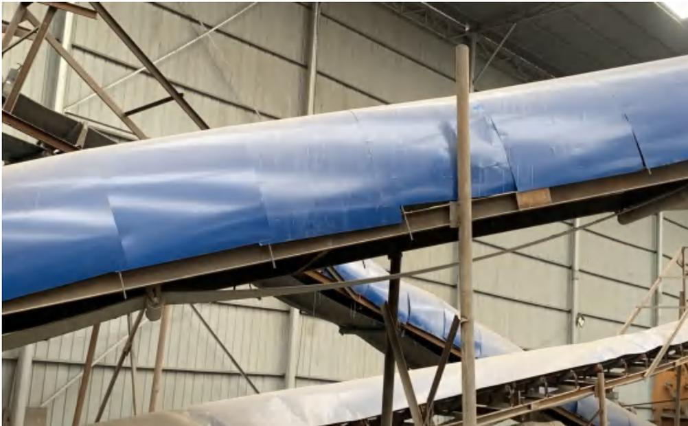
图 3-14 皮带输送机封闭照片
