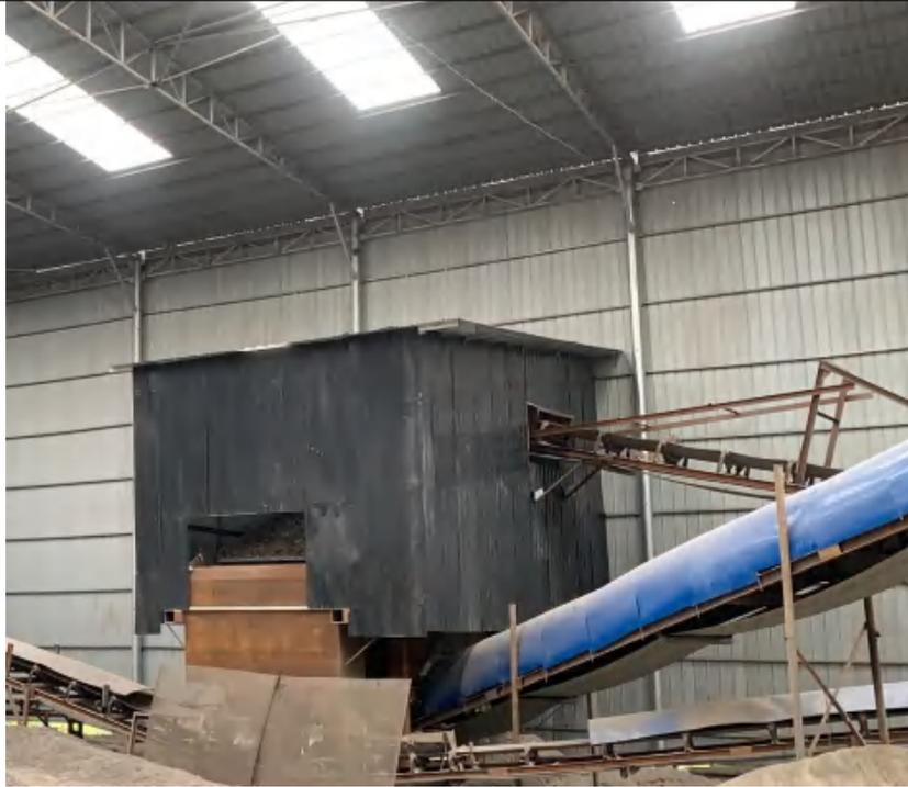
图 3-13 破碎机封闭照片
