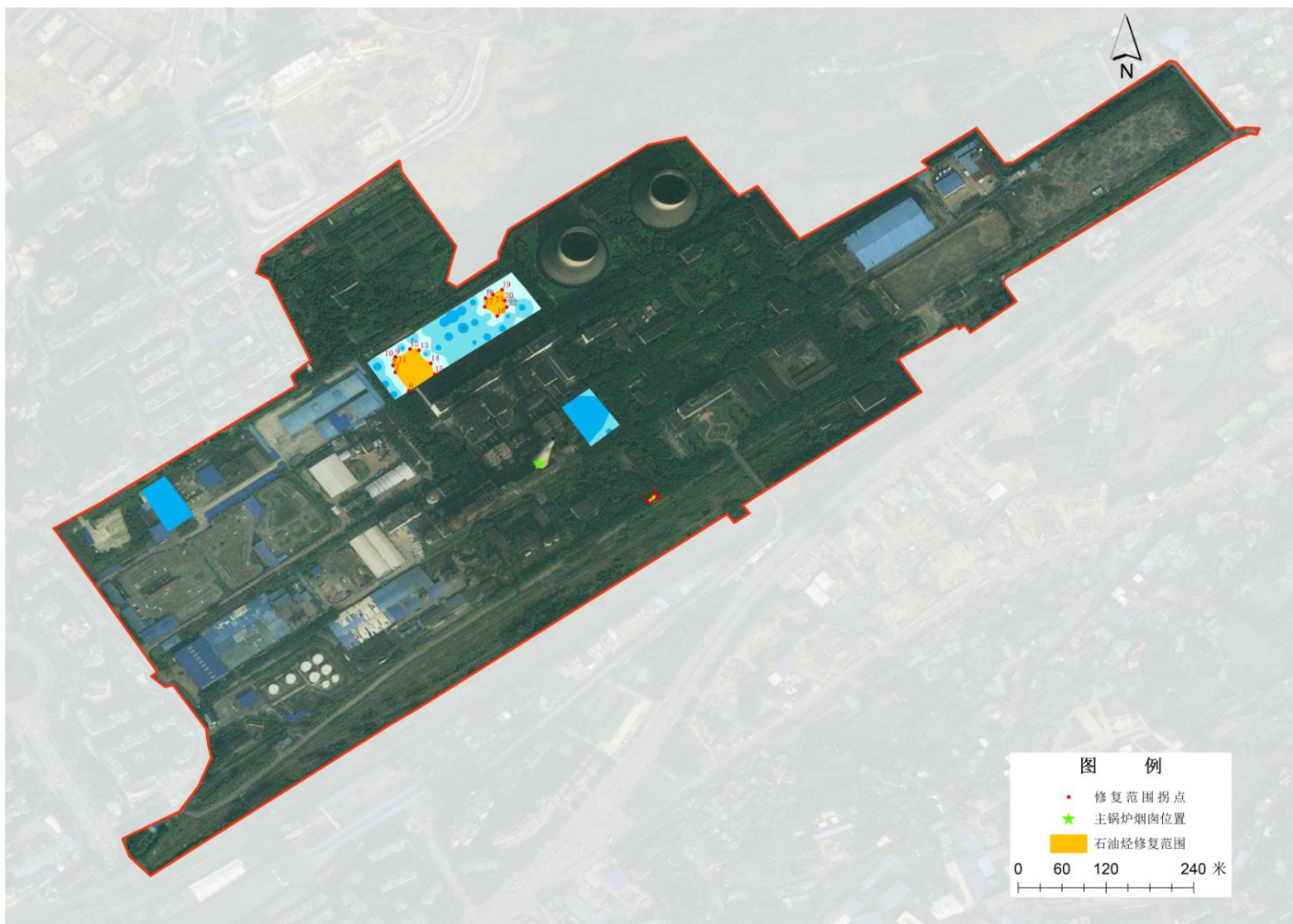
图3-17石油烃（C 10 -C 40 ）20-60cm土壤层修复范围图
