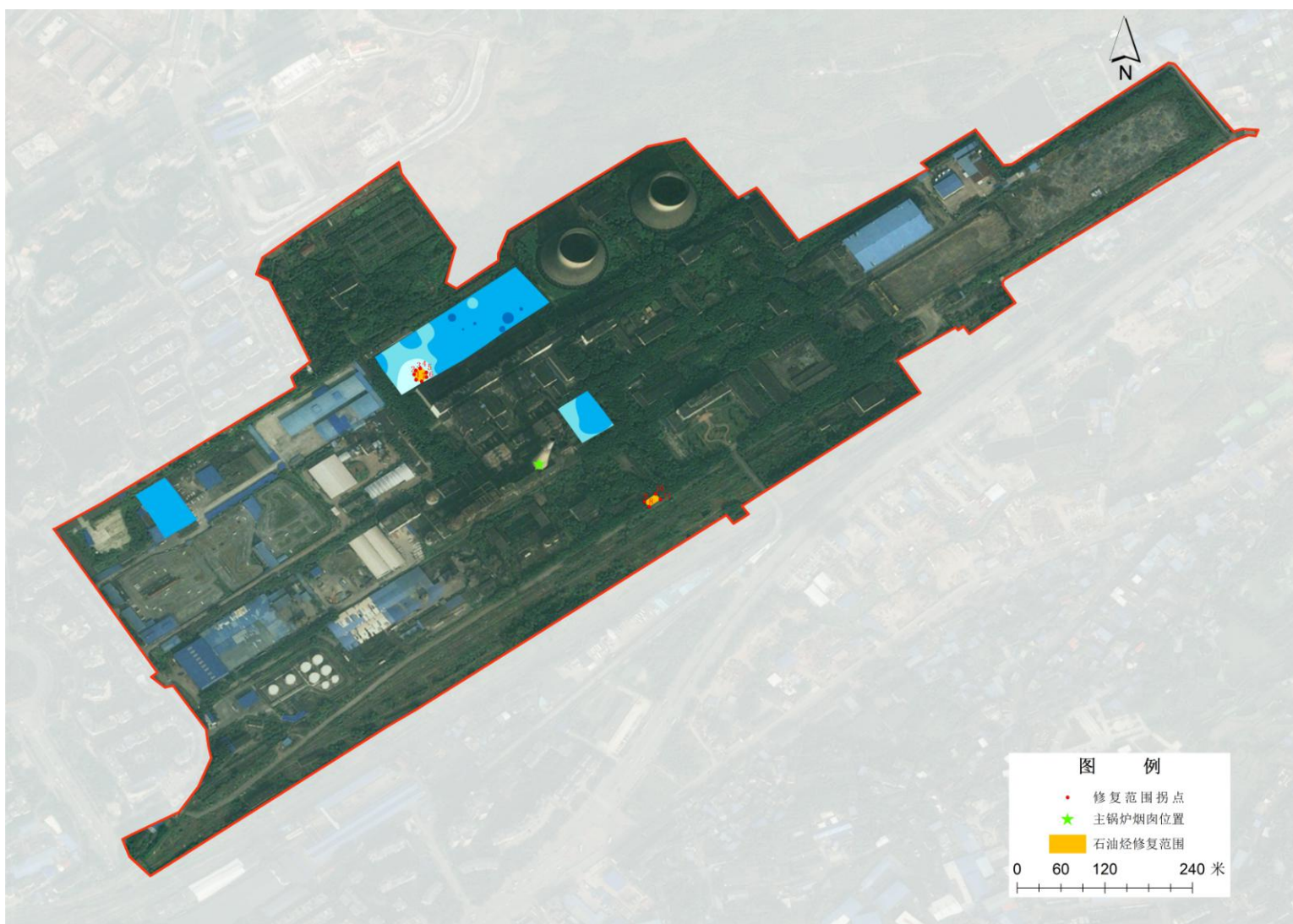
图3-18石油烃（C 10 -C 40 ）60-100cm土壤层修复范围图
