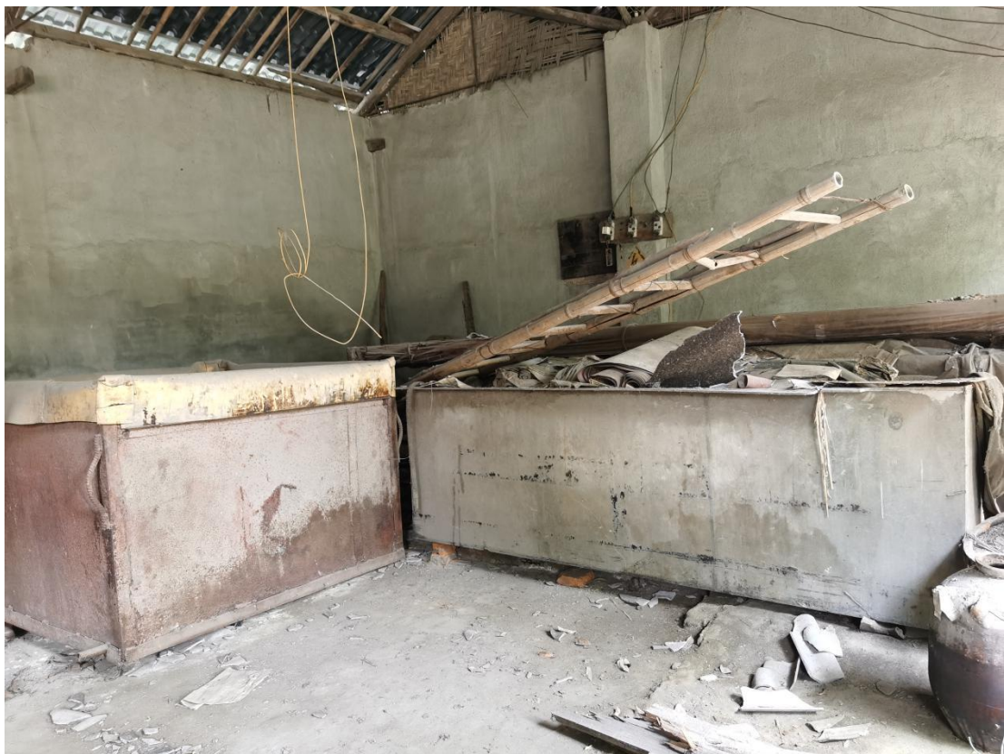
抛光区1（原镀锌车间）遗留槽体
